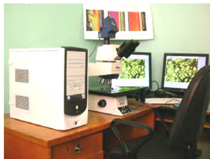
Рисунок 1 – Металлографический комплекс на основе микроскопа МИКРО-200 для анализа микроструктуры металлов и неметаллических материалов в ГНУ «ФТИ НАН Беларуси»
