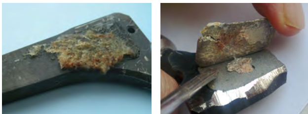
Рисунок 2 – Внешний вид удалённого эндопротеза с конгломератом костной ткани на поверхности пористой титановой вставки (слева); внутренняя сторона вставки с костным «выступом» заполняющим отверстие, соединяющее вставки эндопротеза (справа)
