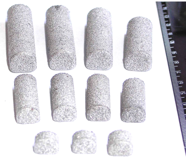
Рисунок 1 — Пористые имплантаты шейных и грудных позвонков, изготовленные из порошка титана марки ПТХ-2-1 имплантатов в костное ложе после резекции или полного удаления тел шейных и грудных позвонков на различных уровнях (рисунок 2).
